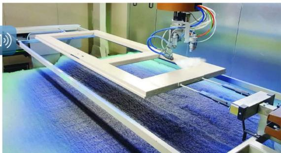
Giardina Group presenta "Robotech GS15 Doors", un sistema avanzato per la verniciatura automatica di porte e pannelli, progettato per garantire la massima efficienza, qualità e produttività. Questo innovativo sistema integra due diverse tecnologie di verniciatura e si distingue per la capacità di adattarsi a qualsiasi tipologia di porta, grazie alla possibilità di memorizzare e richiamare programmi, percorsi e parametri di verniciatura personalizzati.
